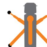
Todos los estabilizadores han sido diseñados para estabilizar la máquina de forma correcta en espacios muy reducidos.
