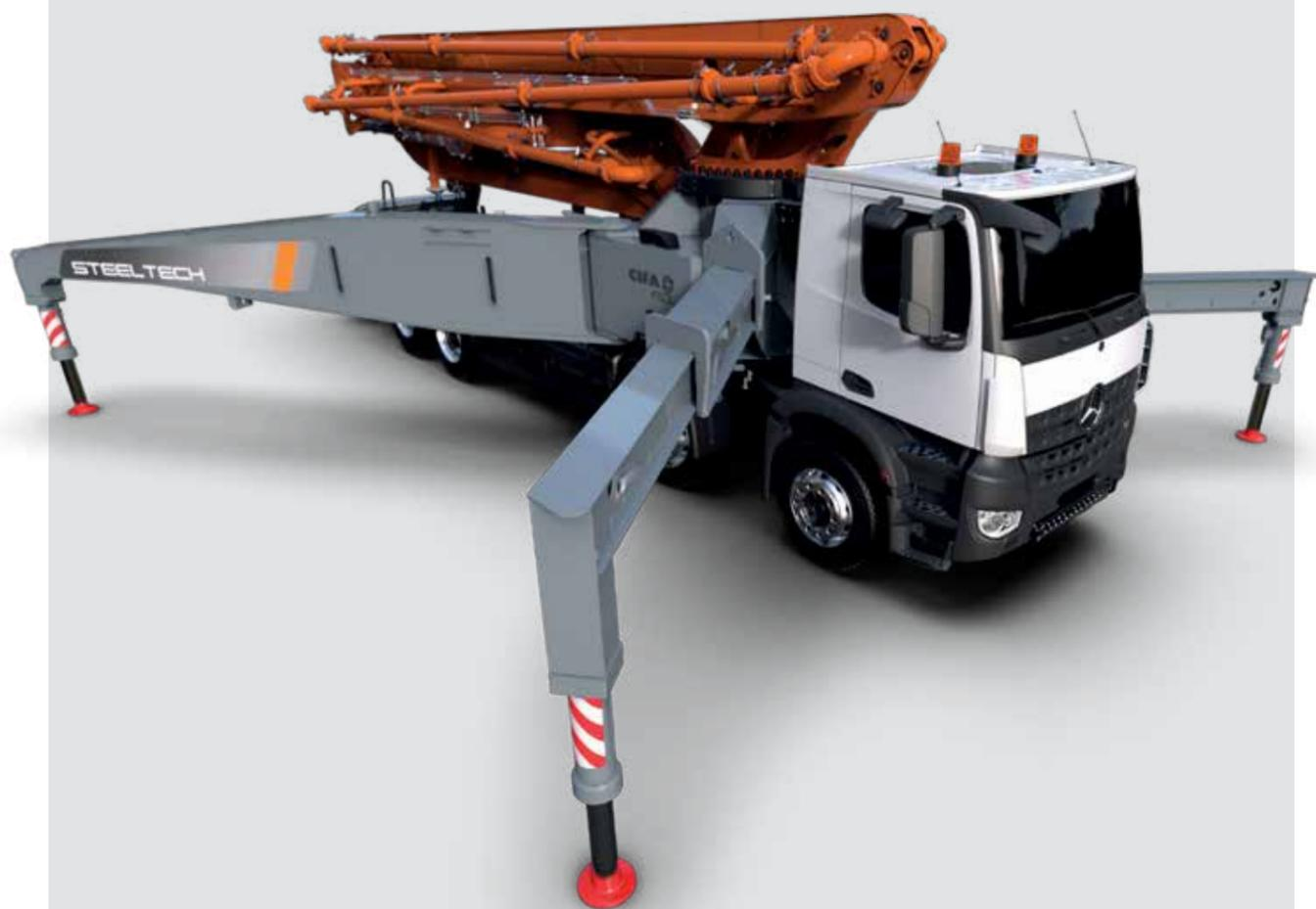
La estabilización delantera está disponible en cuatro conceptos de diseño: estabilizadores individuales horizontales, o individuales, dobles y triples telescópicos en X. La estabilización trasera está disponible en tres conceptos de diseño: fija, de extensión simple y abatible. Cada máquina posee su sistema de estabilización según el tamaño de la pluma.
